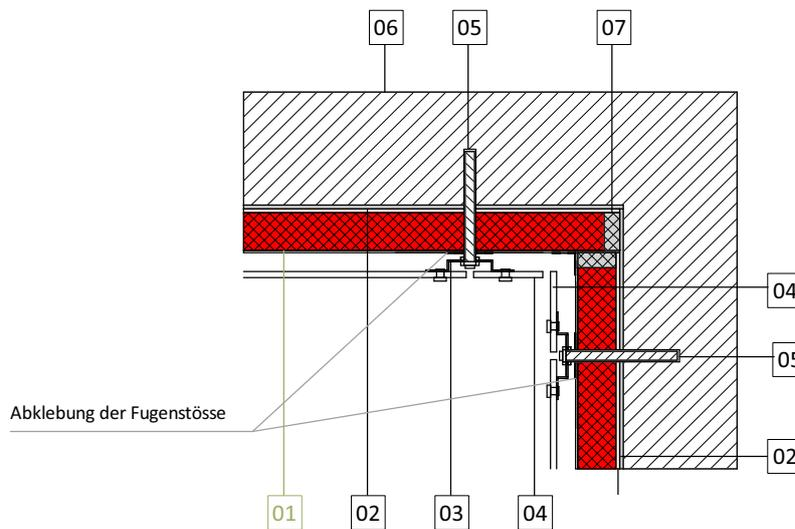
Bzgl. Wärmebrücken, Maßtoleranzausgleich und Stoßabklebung beachten Sie bitte Datenblatt Nr. 499 / Pkt. 4.6 zur Verwendung von Comprind und Klebebändern der „allgemeinen VARIOTEC Verarbeitungshinweise für VIP/QASA-Bauteile“.
