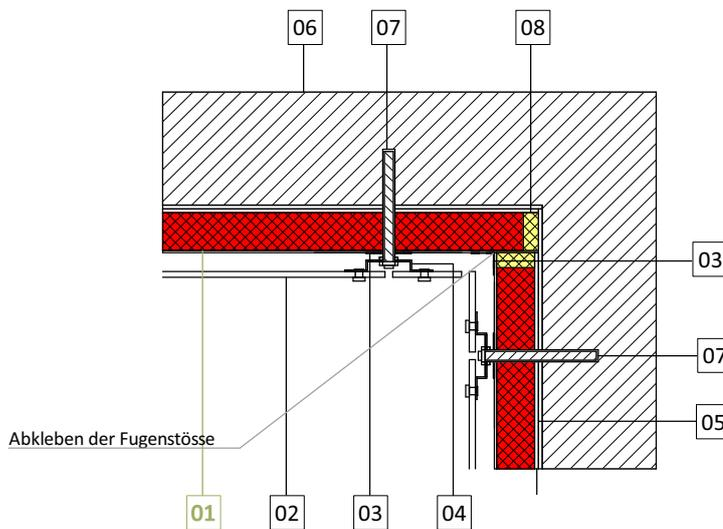
Bzgl. Wärmebrücken, Maßtoleranzausgleich und Stoßabklebung beachten Sie bitte Datenblatt Nr. 499 / Pkt. 4.6 zur Verwendung von Comprind und Klebebändern der „allgemeinen VARIOTEC Verarbeitungshinweise für VIP/QASA-Bauteile“.
