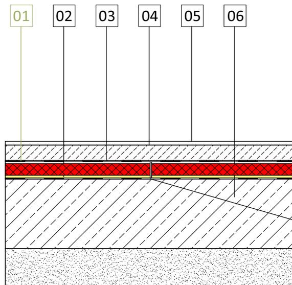
Elementstoss mit Compriband
