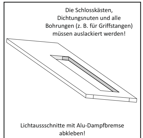
Montage Horizontaldichtung (HZD) in vorgefräster Nut unten.
