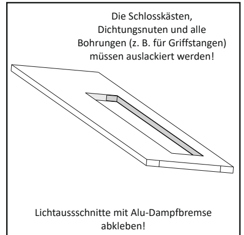
Montage Horizontaldichtung (HZD) in vorgefräster Nut unten.
